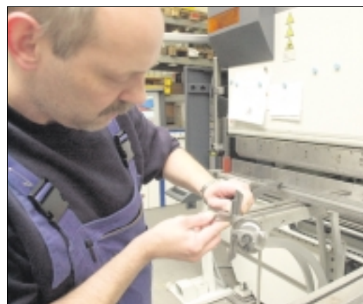
Andreas Kewitsch arbeitet an der Abkantpresse, wo Bleche präzise gekantet werden.
