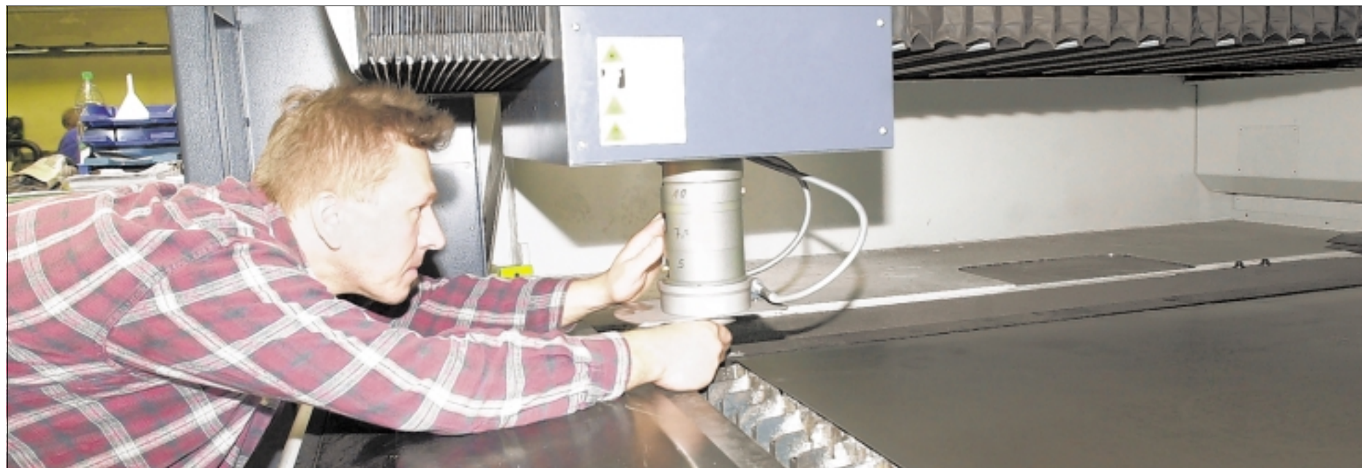
Marko John an der Laserschneid-anlage, deren Strahl Blech bis zu einer Dicke von 20 Millimetern präzise schneiden kann. Neben der Abkantbank die zweite Anlage, in die J.I.M. dieses Jahr investiert hat. Fotos: Rohr
